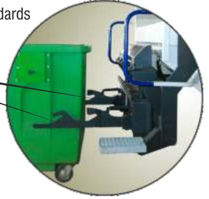
**En option :** Basculeur de norme Européenne (système de levage et basculement de bacs à roues standards de capacité allant de 120L jusqu'à 1100 L.
