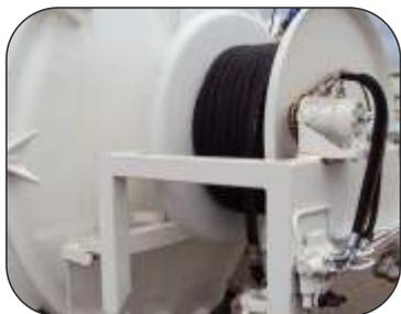
**50 MÈTRES DE TUYAU EN TRESSE MÉTALLIQUE POUR HAUTE PRESSION DE 5/8 AVEC ACCOUPLEMENTS.**
